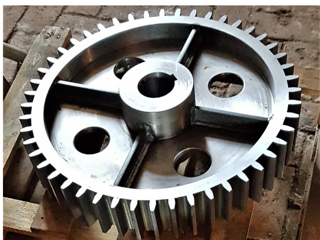
Le pignon qui entraînera les meules réalisé gracieusement par les établissements Mengin d'Amilly et Avezard et Lasne de Villemandeur
